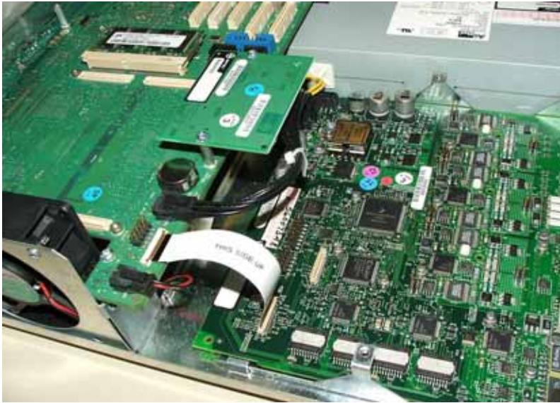
Figure 43: CX/CXi AMB ribbon cable
