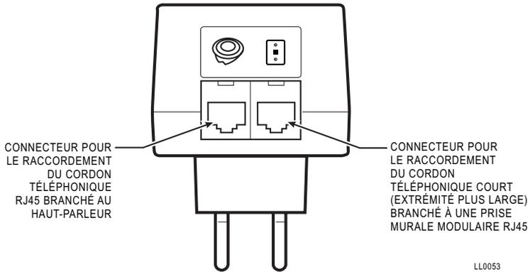
**Figure 2 :** Adaptateur de courant continu de 48 volts
